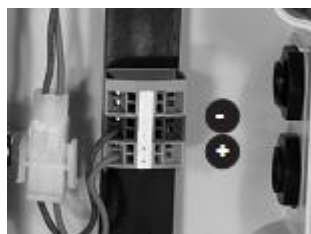
Bild 2a/fig. 2a/Рис.2a/Fig.2a Netzanschluss 24 V DC/Mains connection 24 V DC/Соединения питающих сетей 24 В постоянного тока/schéma des connexions 24 V CC
